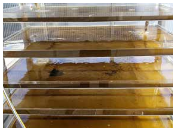
Figur 26. Mikroalger odlas på land (A) och används huvudsakligen som foder för larv-/yngelstadier till olika vattenbruksarter. (B) Försök görs också med odling av kiselalger i biofilmssystem. Algerna växer på närsalter från RAS fiskodling och biofilmen skördas veckovis för vidare industriell beredning.
