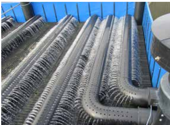
Figur 17. Borttagning av koldioxid, för reglering av pH. Två olika typer av filter för avluftning av koldioxid i RAS anläggning. Systemen utökar ytan mellan vatten och luft så att koldioxid kan avgå i gasform från vattnet till luften och resultatet blir att pH i vattnet därmed höjs.
