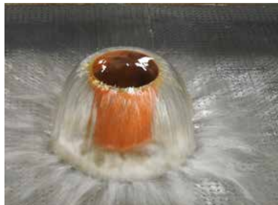
Figur 17. Borttagning av koldioxid, för reglering av pH. Två olika typer av filter för avluftning av koldioxid i RAS anläggning. Systemen utökar ytan mellan vatten och luft så att koldioxid kan avgå i gasform från vattnet till luften och resultatet blir att pH i vattnet därmed höjs.
