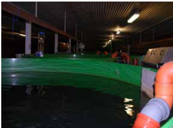
Figur 15. Landbaserade odlingssystem med recirkulerande vatten, så kallat RAS. (A) Svensk odling av abborre (B) och steglet (stör) .
